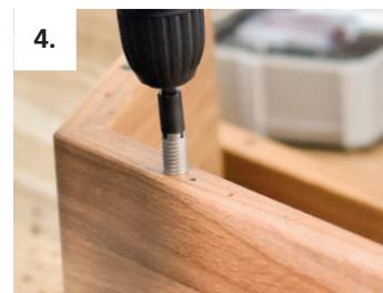
4. Enrosque el elemento de ensamblaje Invis Mx2 a ras en la balda
