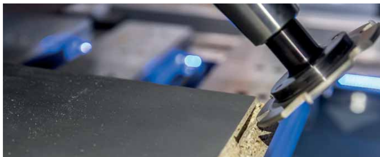
Fresado de ranuras con perfil P-System con el Homag Venture 316 L CNC 5-ejes
