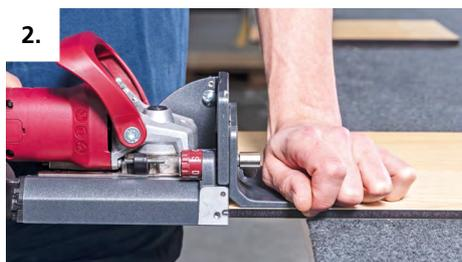
2. Utilizar el ajuste 20 y realizar el fresado frontal en una base de estante de 8 mm.
