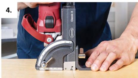
4. Alinear la máquina con la hendidura central y realizar el fresado en la superficie.
