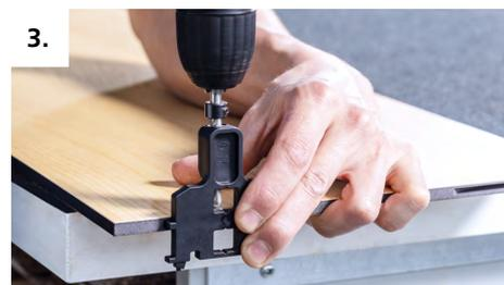
3. Taladrar un orificio de acceso de 6 mm en el estante con ayuda de la plantilla de perforación y alineación.
