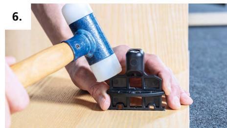
6. Golpear el elemento de ensamble suavemente con un martillo para alinear de forma que quede paralelo a la superficie.
