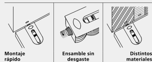
Cabineo 8 M6 es un elemento de ensamble para armazones de una pieza que se puede utilizar con todas las máquinas CNC, ya que solo se trabaja en la superficie. Es ideal para la unión de materiales de madera con materiales como aluminio, acero o HPL.
