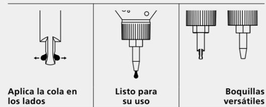
Minicol es un aplicador de cola universal y la solución ideal para la aplicación de cola en fresados de 4 mm.
