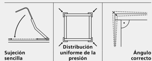
El juego de abrazaderas es un sistema para el encolado de armazones y otras muchas piezas de mobiliario y completa el sistema Lamello. Consta de perfiles para proteger los cantos, cintas de 8 metros de longitud y dos ganchos tensores. A diferencia de las abrazaderas, la distribución de la presión es siempre uniforme, por lo que los muebles se tensan automáticamente en ángulo recto, ya sea en el encolado de paneles obtusos o ingletes.
