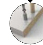
Integrar con pernos de orientación en el lateral y insertar la espiga en el costado
