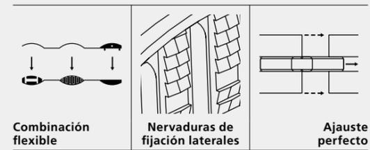
El K20 es un elemento de fijación que se puede utilizar con cualquier engalletadora Lamello.
