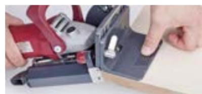
**Precisión al fresar ingletes** con su superficie de apoyo para ángulos de 22.5° y 45°
