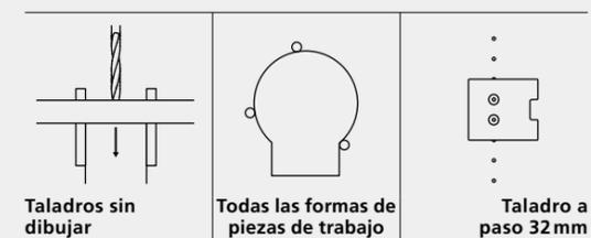
Rasto es una plantilla de taladrado universal y sirve para realizar orificios precisos para Invis Mx2. La plantilla de taladrado puede fijarse a casi cualquier forma de pieza por medio de tres pernos de posicionamiento sin medir ni marcar. Después de perforar la primera pieza, la posición se transfiere a la segunda pieza sin cambios. De este modo, los orificios coinciden siempre de forma precisa.
